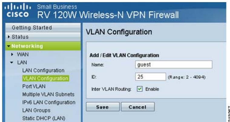
Abbildung 2 Hinzufügen/Bearbeiten der VLAN-Konfiguration
