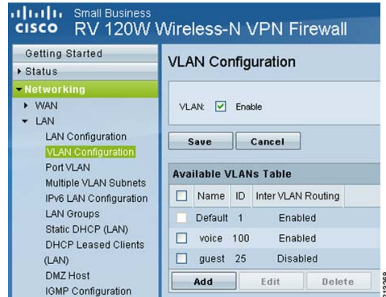
Abbildung 3 Aktivieren und Speichern der VLAN-Konfiguration
