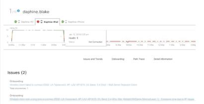
トラブルシューティング診断ポップアウトボックスに、問題の詳細と、取るべき対応案が示されます。(23) Daphine の IPAD は、AAA サーバによって拒否されていました。Daphine は、サンタモニカ(レベル 1)の SSID LA-Topsecret3 への接続を試みていたのですが(ポップアウトの説明を参照)、影響を受けていたクライアントは Daphine の IPAD だけです。
