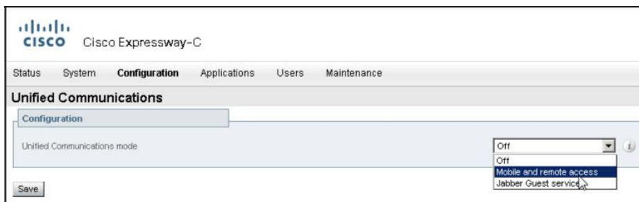
図 A.19 Expressway-C で Mobile and Remote Access を有効化
