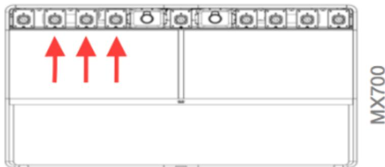
3. 一次只能校正一台显示器, 如果你校正的是**右边**的显示器。拔出以下红色箭头指示的 USB 口连接的 USB 公头, 并且连接到你的电脑上。
