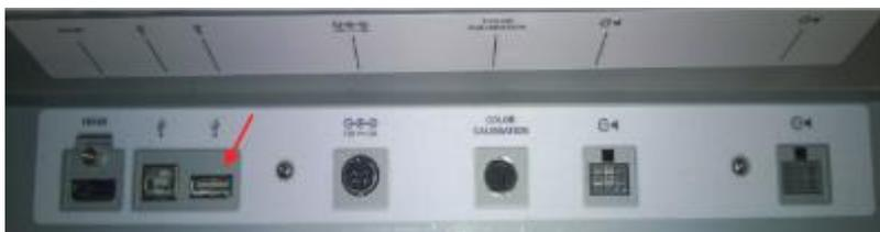
4. 如果校正的是**左边**的显示器, 拔出红色箭头指示的 USB 口连接的 USB 线的母头, 使用自己的 USB 线连接到这个母头或者直连到 MMB 面板的 USB 口, 另一端连接到你的电脑上。
