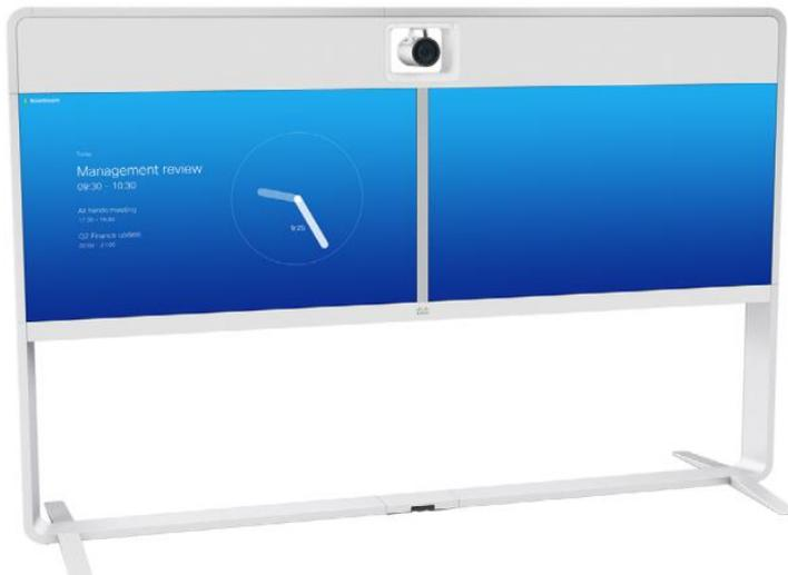
MX700 自带的显示屏没有物理调节按钮，需要通过 USB 接口连接到电脑后，用工具调整色彩，这篇文档介绍如何使用工具校准 MX700 终端的显示屏色彩。
