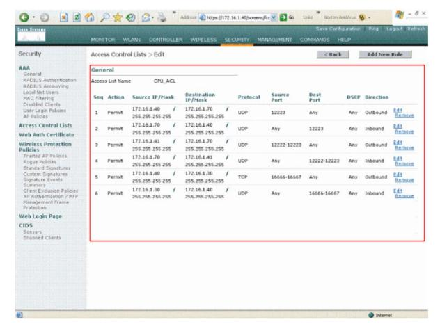
当CPU ACL创建完成后, 你需要应用到无线控制器上。在无线控制器的CLI上输入如下命令, 把CPU ACL应用到无线控制器上:
