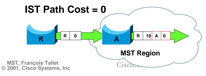
**Root ID Root Path** Cost Sender **Bridge ID Sender Port Priority BPDU**
